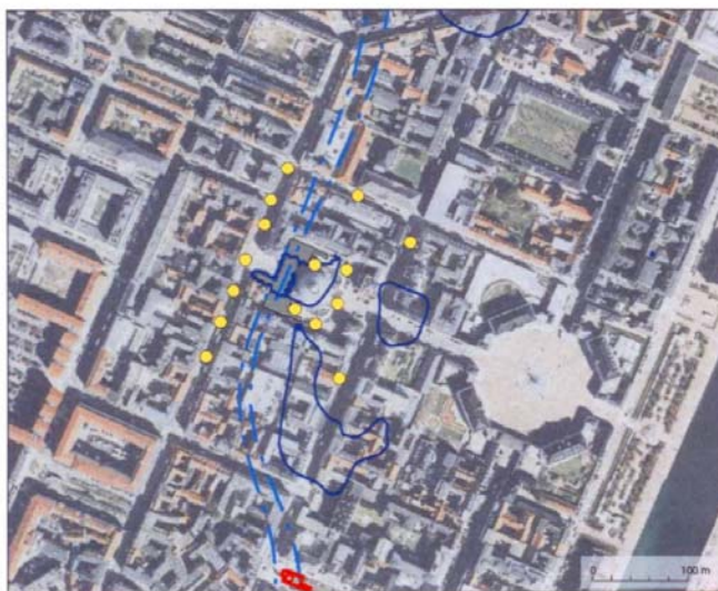
Grundvandsmodelkørsel med eksempel på anvendelse af afværgeforanstaltninger — Tunnel — Modelleret sænkning ▭ Byggegrube ▭ Konstruktion i grundvandsmodel ● Infiltrationsboring
